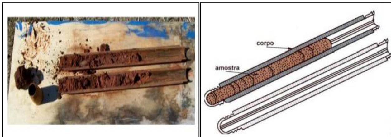
Figura 3 – Detalhe: Amostrador Padrão
